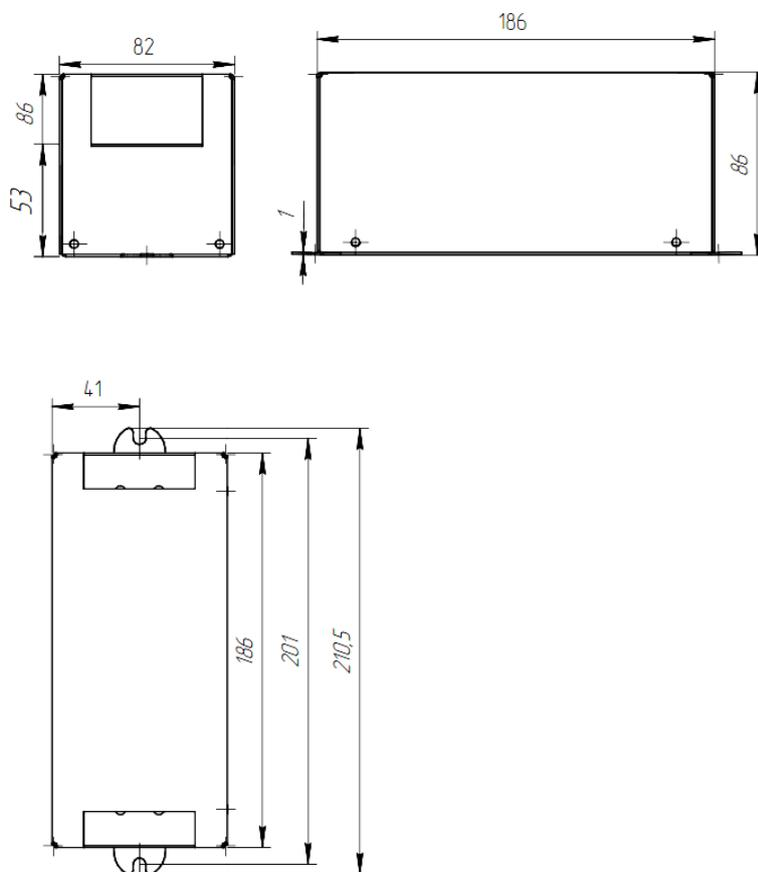
Рисунок 2 — Габаритные размеры фильтров ФП-ВТ-45, ФП-ВТ-60, ФП-ВТ-3080
