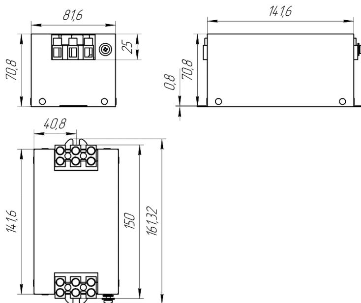
Рисунок 1 — Габаритные размеры фильтра ФП-ВТ-3030
